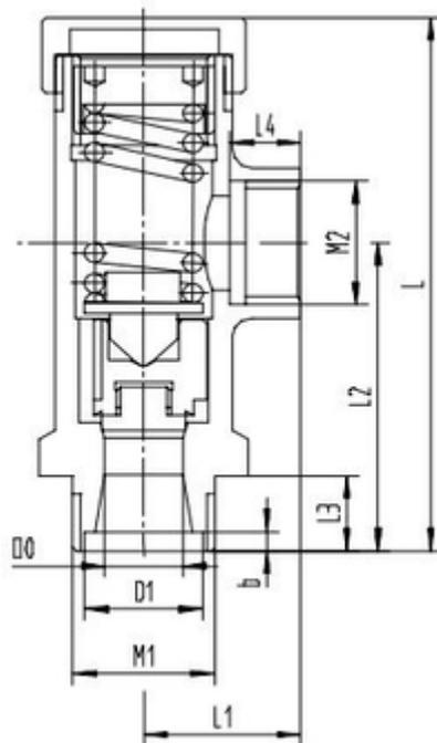
Предохранительный клапан криогенный ССК тип Т7К10-25 PN40.
