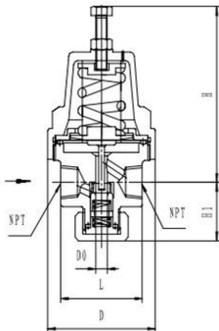
Криогенный регулятор давления "после себя" типа T287DE15-50, настройка давления от 0,2 до 1,6 МПа.
