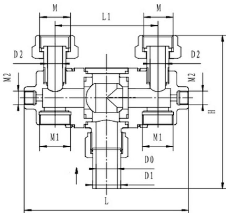
Криогенный переключающий кран с портами для установки разрывных мембран ССК типа Т304DQ25-32, PN40
